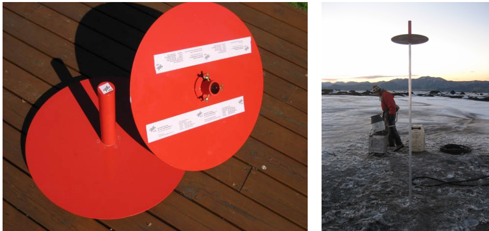
Abb. 5. Ansicht von zwei Top-Hat Reflektoren (links) und einem auf dem Sléttjökull errichteten Top-Hat Reflektor (rechts).
